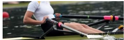
Carbon-Druckstreben-Ausleger an „Roadrunner“ 7
